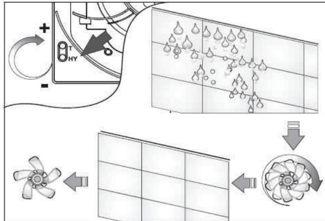
Juster timerens trimmer som illustreret, for at øge eller mindske ventilatorens efterløbstid.
